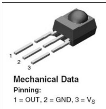
Sensore infrarossi con preamplificatore, demodulatore e filtro tarato sulla frequenza di 56 kHz. Uscita compatibile con dispositivi TTL e CMOS, alimentazione compresa tra 2,7 e 5,5 volt. Dotato di filtro a infrarossi che lo rende altamente immune alla luce ambiente. Velocità di trasferimento dati fino a 4000 bit/s. Questo sensore infrarossi è utilizzato nel prodotto 7300-IRBEACON. Dimensioni:
