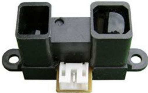
Sensore infrarossi in grado di rilevare un ostacolo in una distanza compresa tra 20 e 150 cm. Il sensore fornisce in uscita una tensione che varia in funzione della distanza. Per sapere la distanza rilevata è necessario interfacciare l'uscita ad un microcontrollore, ad un convertitore analogico-digitale oppure può essere collegata ad un comparatore per la rilevazione della soglia. Ideale per applicazioni nella robotica.
