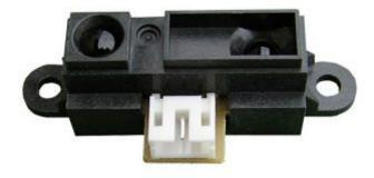
Sensore infrarossi in grado di rilevare un ostacolo in una distanza compresa tra 4 e 30 cm. Il sensore fornisce in uscita una tensione che varia in funzione della distanza. Per sapere la distanza rilevata è necessario interfacciare l'uscita ad un microcontrollore, ad un convertitore analogico-digitale oppure può essere collegata ad un comparatore per la rilevazione della soglia. Ideale per applicazioni nella robotica.
