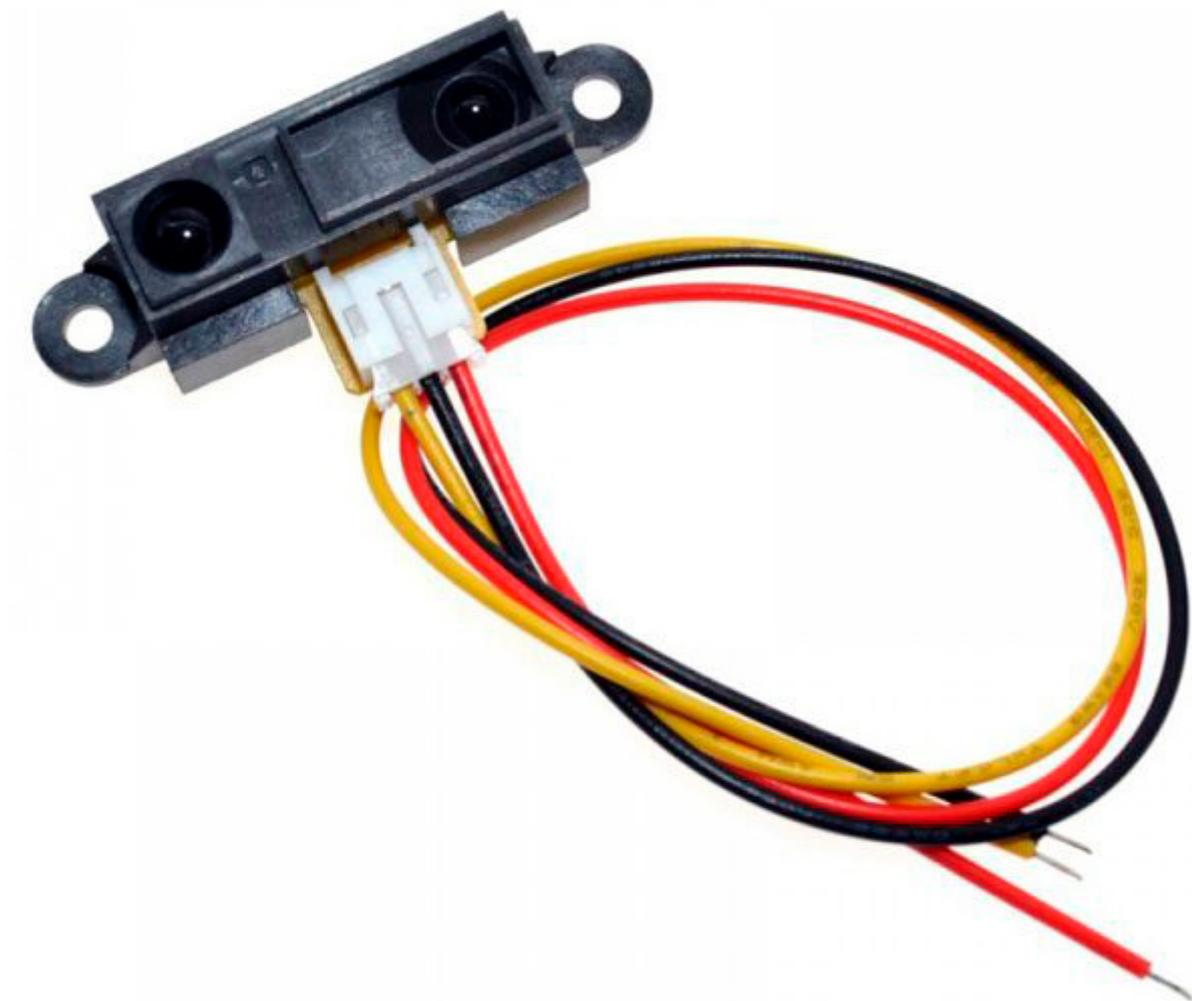
Sensore infrarossi in grado di rilevare un ostacolo in una distanza compresa tra 10 e 80 cm. Il sensore fornisce in uscita una tensione che varia in funzione della distanza. Per sapere la distanza rilevata è necessario interfacciare l'uscita ad un microcontrollore, ad un convertitore analogico-digitale oppure può essere collegata ad un comparatore per la rilevazione della soglia. Ideale per applicazioni nella robotica, automazione, ecc. **N.B.** cavetto di collegamento incluso.
