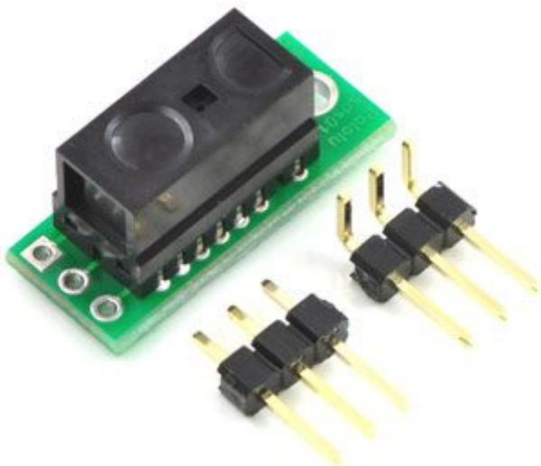
Piccolissimo sensore infrarossi in grado di rilevare un ostacolo in una distanza compresa tra 0,5 cm e 5 cm. L' uscita va a livello basso e accende un LED quando rileva un ostacolo, altrimenti è a livello alto. Il sensore indica che c'è un oggetto all'interno del campo di rilevamento (0,5 cm e 5 cm) e non indica quanto è lontano l'oggetto. Ideale per essere impiegato come rilevatore di ostacoli senza contatto.
