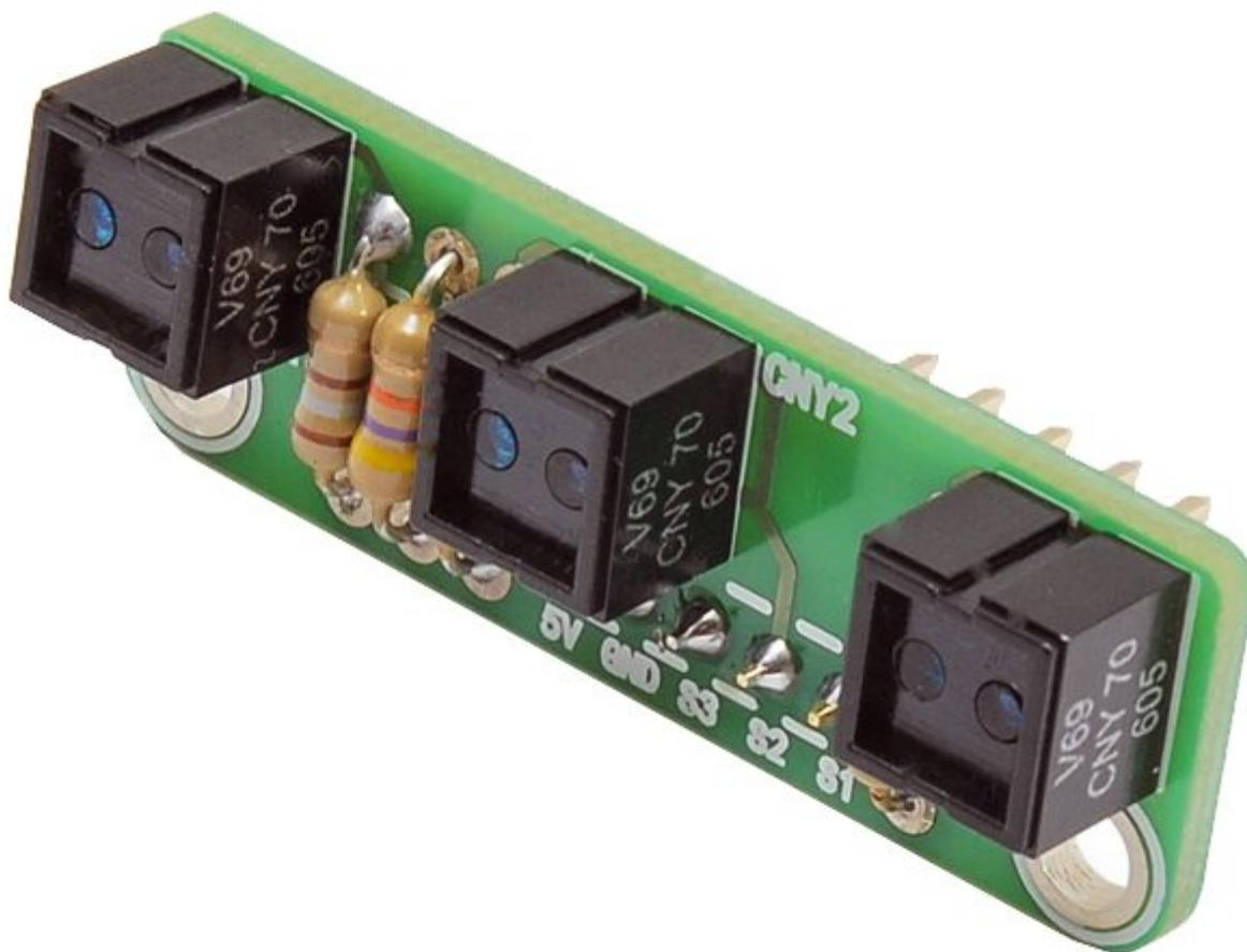
Modulo con triplo sensore a riflessione CNY70, particolarmente indicato per il kit EasyRobot (vedere correlati) e non solo. Fornisce in uscita una tensione inversamente proporzionale al livello di riflessione del suolo in cui si trova ad operare, sfondi chiari forniranno tensioni basse e viceversa sfondi scuri forniranno valori alti. Alimentazione: 5 Vdc, dimensioni (mm): 39x14.
