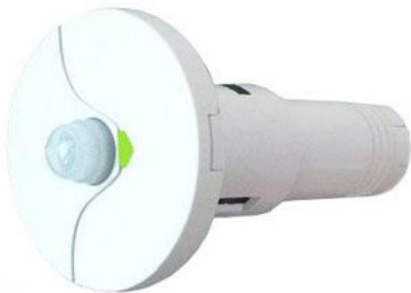
PIR ultra compatto per interni con tecnologia di rilevazione digitale del moto, montaggio da incasso e lente grandangolare (60°). Dispone di contatto normalmente aperto, range di rilevamento: 9 m x 9 m e immunità da luce bianca. Particolarmente indicato per montaggio a parete o soffitto. Alimentazione: da 9,6 a 16 Vdc.
