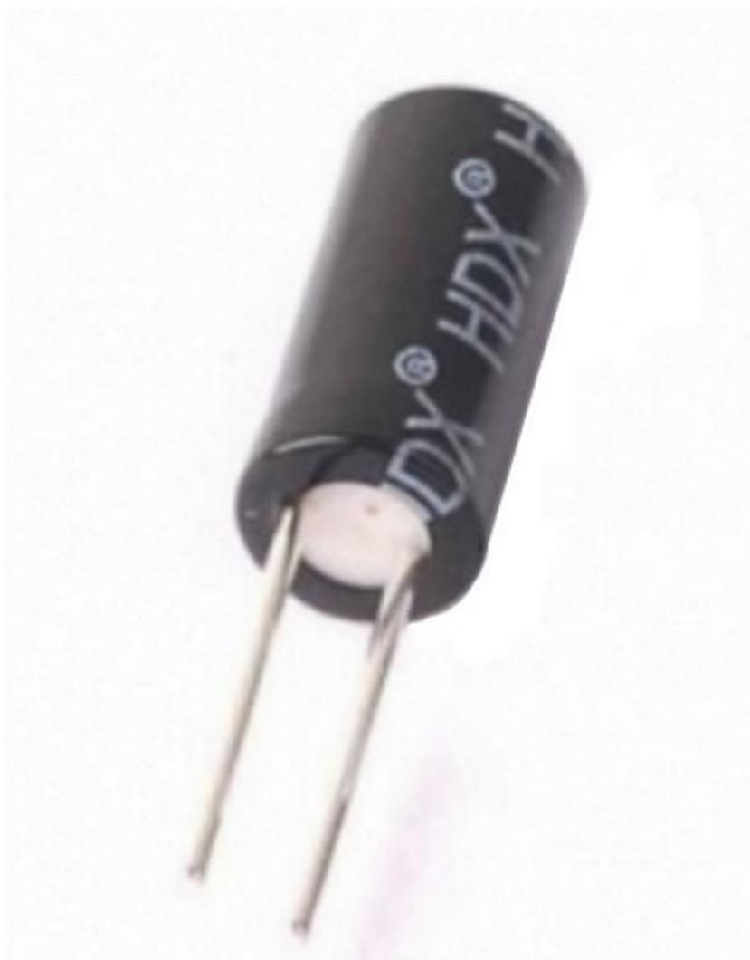
Sensore di movimento meccanico a sfera in grado di rilevare spostamenti, inclinazioni o vibrazioni. Contatto a riposo normalmente aperto ( OFF ), quando viene applicato il movimento o un inclinazione il contatto si chiude, ( ON ). Completamente sigillato per consentire di operare in ambienti umidi o polverosi.
