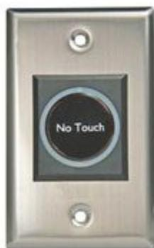
Sensore ottico di prossimità che, al semplice passaggio della mano (senza contatto), permette l'attivazione di un relè. Particolarmente indicato per l'apertura automatica di cancelli, porte, accensione luci, ecc. Tecnologia infrarossa, tenuta stagna (IP44).
