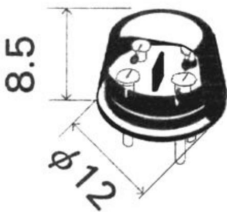
Sensore da impiegare in rilevatori per fughe di gas combustibili. Range di misurazione: 1~ 100% LEL (limite inferiore di infiammabilità). Alimentazione: AC, DC 2,50 V  $\pm$  0,25 V, corrente: 170 ~ 190 mA. Applicazioni: rilevatori per fughe di gas combustibili.
