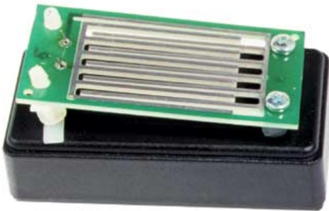
Semplice ma efficace sensore in grado di rilevare la caduta della pioggia. E' costituito da una griglia inclinata a forma di doppio pettine sulla quale cadono e permangono per un certo periodo le gocce di pioggia provocando una variazione di stato dell'uscita. In assenza di pioggia il contatto rimane aperto.
