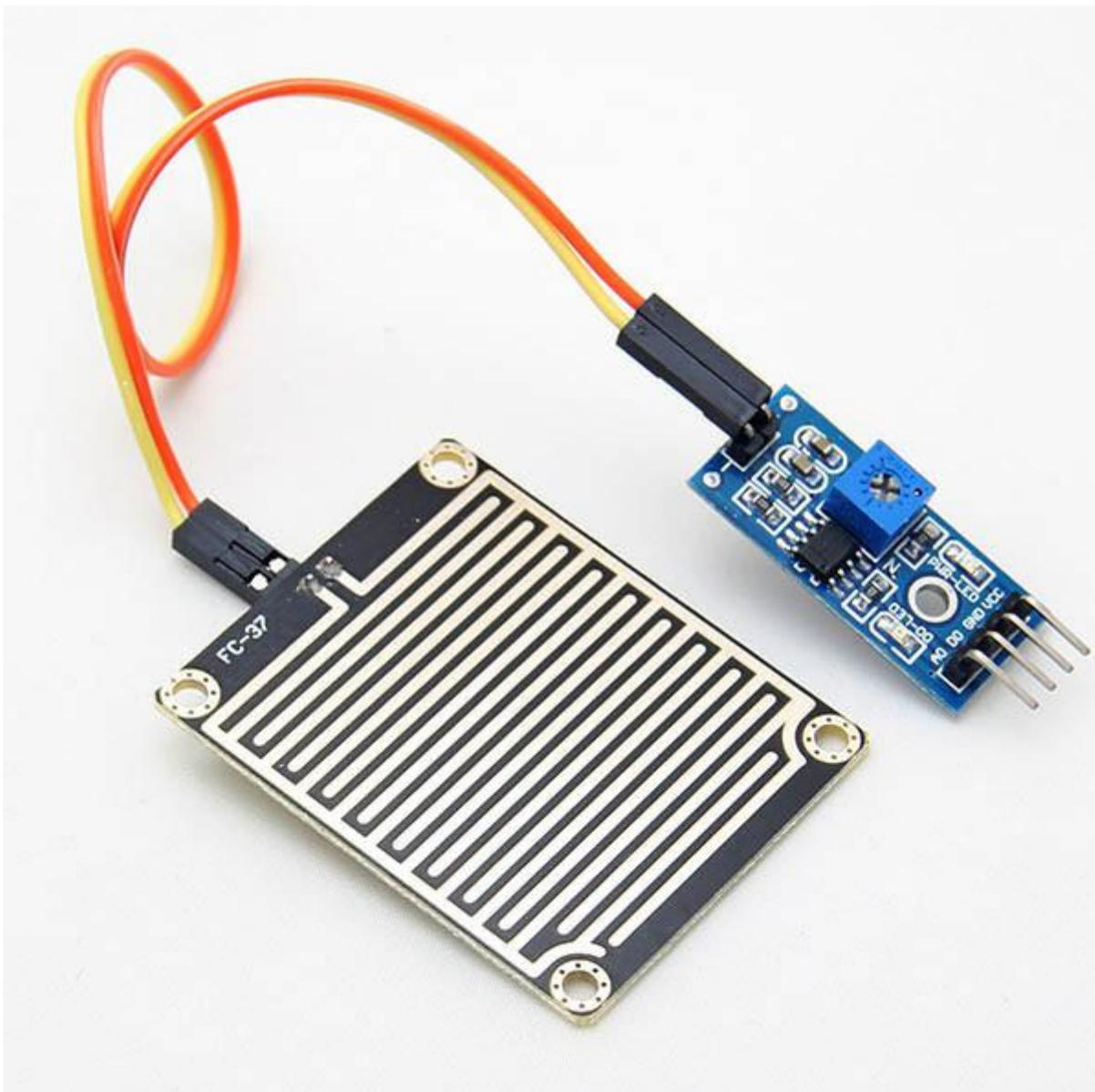
Composto da un basetta con ampia area di rilevamento (34x47 mm) su entrambe le facce ed elettronica di controllo, questo prodotto è particolarmente indicato come rilevatore di pioggia. La sezione elettronica dispone di una uscita analogica, una digitale, un trimmer per regolare la sensibilità d'ingresso e due LED di stato. L'uscita digitale D0 può pilotare direttamente dispositivi con assorbimento massimo di 100 mA come relè, buzzer, piccole ventole, ecc. Quando l'area di
