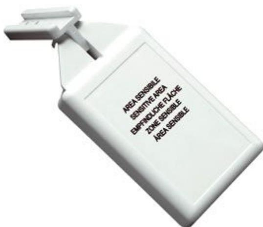
Semplice ma efficace sensore in grado di rilevare la pioggia caduta sulla sua area sensibile e attivare una trasmissione a 433,92 MHz. Può essere utilizzato in abbinamento al mini ricevitore a due canali ad auto apprendimento FR458. Alimentazione: 12 Vcc / Vca, assorbimento: 10 mA. L'unità dispone di un relè interno che permette il funzionamento anche in modo totalmente autonomo segnalando la presenza di pioggia.
