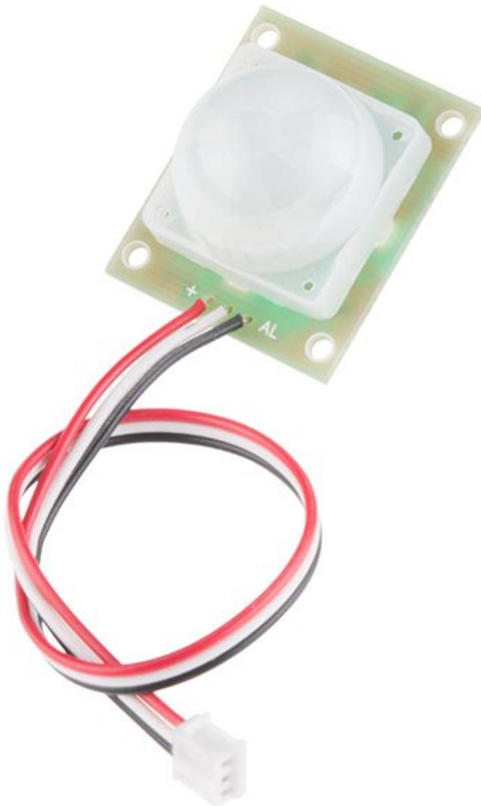
Rilevatore ad infrarossi passivi con uscita open collector. Dispone solamente di tre piedini (allarme, positivo e negativo di alimentazione). Il pin di allarme è [open collector](#), questo significa che è necessaria una resistenza di pull-up. L'alimentazione deve essere una tensione continua di 12 volt stabilizzati.
