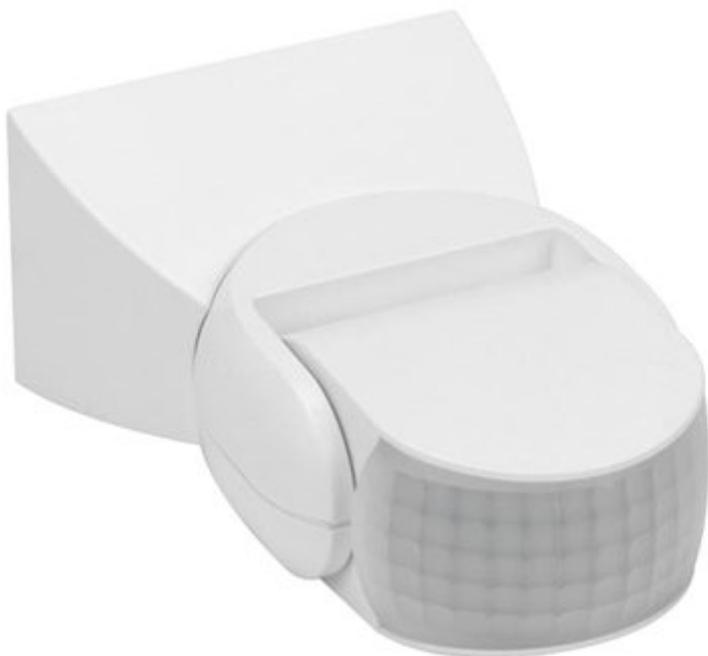
Sensore di movimento ad infrarossi passivi con grado di protezione IP65. È in grado di attivare, al passaggio di una persona, un carico per un periodo di tempo regolabile tra 10 secondi e 15 minuti. Massimo carico controllabile: resistivo 1200 watt e induttivo 300 watt.
