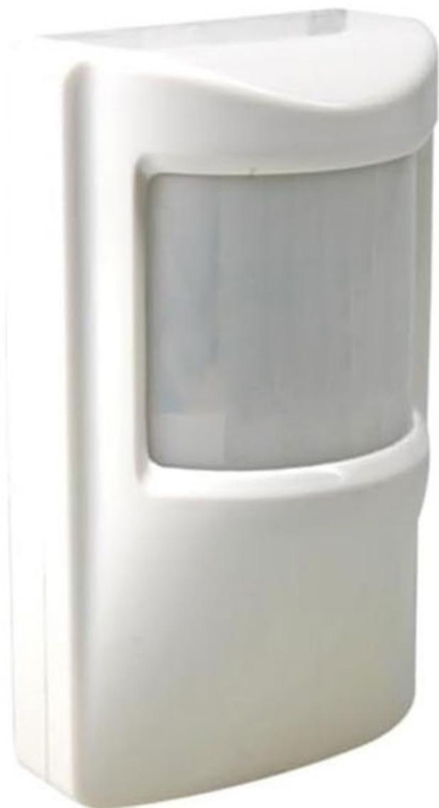
Sensore PIR adatto a qualsiasi impianto antifurto con fili. Elevata immunità ai disturbi grazie al filtro EMI e RFI incorporato. Uscita a relè con contatto N.C. o N.O., alimentazione nominale 12 Vdc. Il sensore viene fornito completo di supporto da parete, viti e tasselli.
