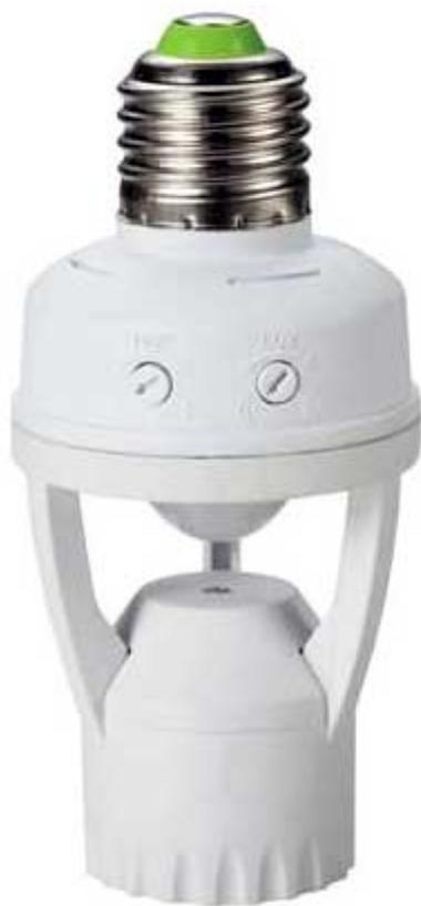
È in grado di attivare al passaggio di una persona, un lampada (attacco E27) per un periodo di tempo regolabile tra 10 secondi e 5 minuti. Massimo carico controllabile: 60 W (lampade ad incandescenza) / 20 W (lampade a risparmio energetico). Alimentazione: 230 Vac / 50 Hz.
