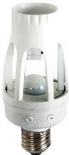
È in grado di attivare al passaggio di una persona, un lampada per un periodo di tempo regolabile tra 10 secondi e 7 minuti. Massimo carico controllabile: 40 W (lampade ad incandescenza) / 20 W (lampade a risparmio energetico). Alimentazione: 230 Vac / 50 Hz..
