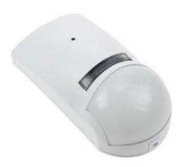
Sensore PIR con rilevatore rottura vetri a microonde adatto a qualsiasi impianto antifurto con fili. Sensibilità regolabile per entrambi i sensori, compensazione automatica della temperatura in funzione di quella ambientale, contatto antisabotaggio.
