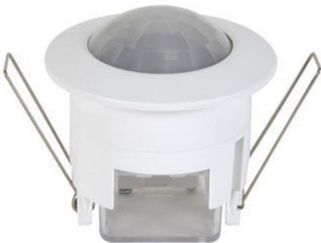
Sensore di movimento ad infrarossi passivi, in grado di attivare al passaggio di una persona, una lampada per un periodo di tempo regolabile tra 10 secondi e 7 minuti. Identificazione automatica giorno/notte, massimo carico controllabile: 1200 W (lampade ad incandescenza) / 300 W (lampade a risparmio energetico). Alimentazione: 230 Vac / 50 Hz.
