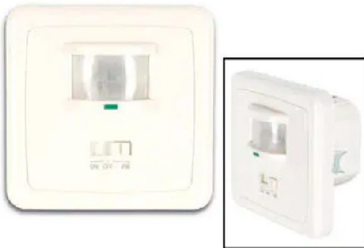
Sensore di movimento ad infrarossi passivi in grado di attivare, al passaggio della persona, un carico luminoso per un periodo di tempo regolabile tra 5 secondi e 7 minuti. Massimo carico controllabile: 500 W, funziona solo con lampadine.
