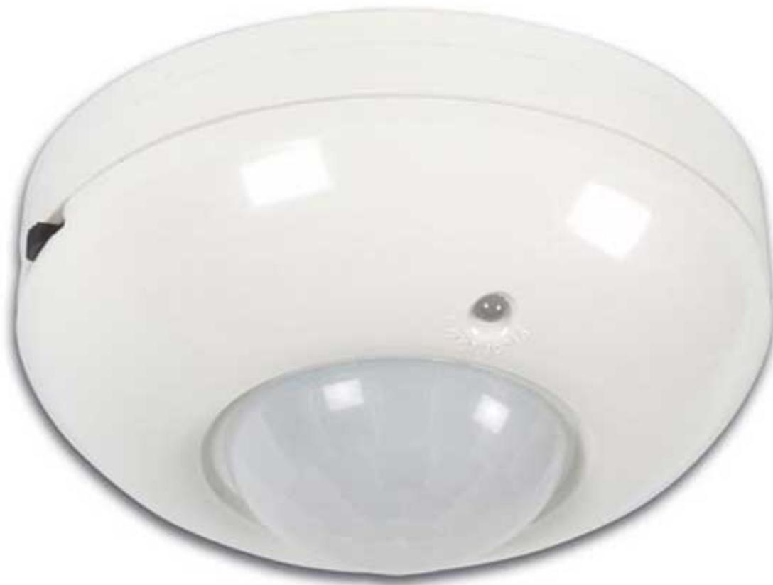
Sensibile sensore PIR da soffitto alimentato con la tensione di rete in grado di pilotare carichi fino a 1200 watt. Regolazione automatica della sensibilità giorno/notte, semplice da installare, elevato raggio di azione, led di segnalazione acceso/spento e rilevazione movimento.
