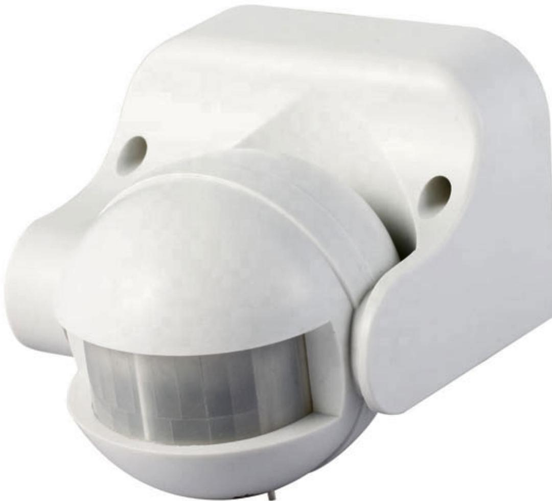
Sensore di movimento ad infrarossi passivi in grado di attivare, al passaggio della persona, un carico luminoso per un periodo di tempo regolabile tra 10 secondi e 7 minuti. Massimo carico controllabile: 1200 W, funzionamento con tensione di rete.
