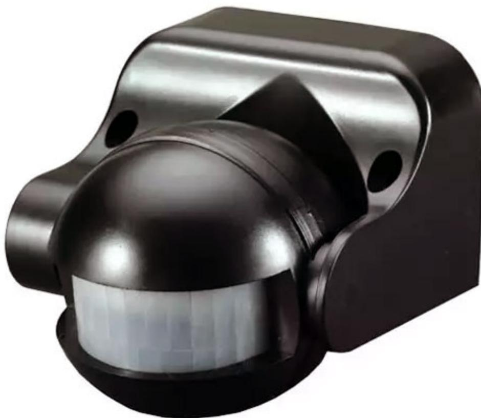
Sensore di movimento ad infrarossi passivi in grado di attivare, al passaggio della persona, un carico luminoso per un periodo di tempo regolabile tra 10 secondi e 7 minuti. Massimo carico controllabile: 1200 W, funzionamento con tensione di rete. Colore: nero.
