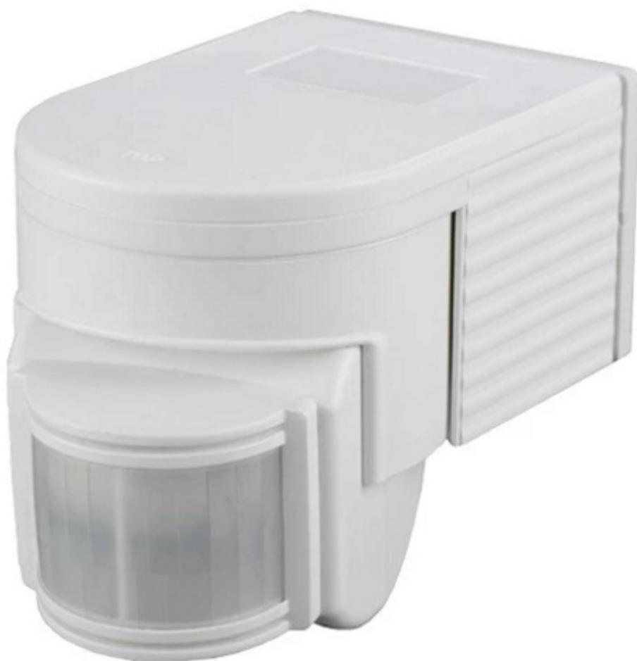
Sensore di movimento ad infrarossi passivi in grado di attivare, al passaggio della persona, un carico luminoso per un periodo di tempo regolabile tra 8 secondi e 7 minuti. Massimo carico controllabile: 1200 W, funzionamento con tensione di rete.
