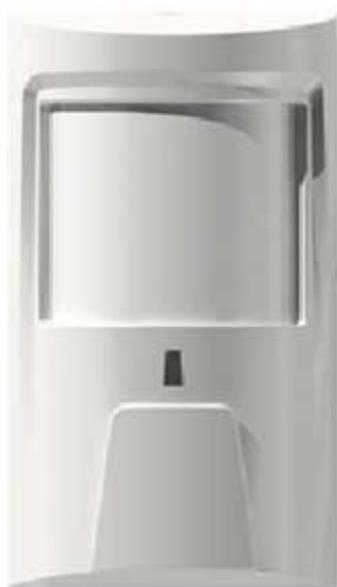
Sensore PIR supplementare per la centralina antifurto wireless GSM/SMS/RFID. Quando rileva un movimento, il trasmettitore interno a 433 MHz invia un segnale codificato alla centrale wireless, facendo scattare l'allarme. Dispone di segnalazione batteria scarica e protezione anti-apertura. Dotato di staffa con snodo che permette di ottenere la giusta inclinazione al fine di coprire in maniera ottimale la zona desiderata.
