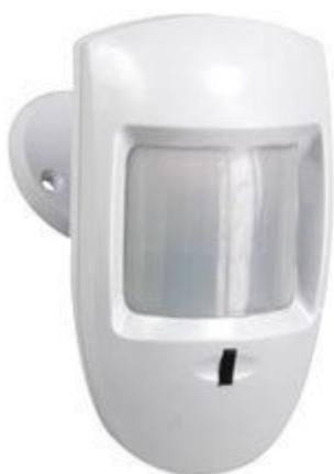
Sensore PIR wireless per centrale antifurto HAM06WS. Angolo di rilevazione: 110°, distanza di rilevazione: 12 m, alimentazione: batteria 9 V - 6LR61(non compresa), assorbimento in standby: 30  $\mu$ A.
