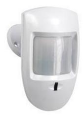
Sensore PIR wireless per centrale antifurto FR522. Portata radio: 50 metri senza ostacoli, angolo di rilevazione: 110°, distanza di rilevazione: 12 m, alimentazione: batteria 9 V - 6LR61(inclusa), assorbimento in standby: 30 µA. Dimensioni: 60x115x38 mm, lunghezza staffa: 55 mm.
