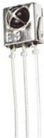
Sensibilissimo sensore IR con preamplificatore, demodulatore e filtro tarato sulla frequenza di 38 kHz - 600  $\mu$ s con amplificatore/squadratore incorporato. Tre soli terminali, alimentazione a 5 V.
