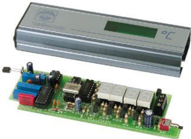
Questo sensore di temperatura presenta le stesse caratteristiche del kit K6001. In aggiunta, è provvisto di display a LED per la visualizzazione di tre parametri : 1) valore della temperatura corrente; 2) valore della temperatura minima programmata; 3) valore della temperatura massima programmata. E' incluso nel kit uno splendido contenitore in alluminio completo di pellicola frontale adesiva.
