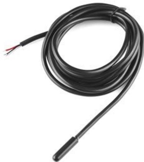
Realizzata con il sensore digitale di temperatura DS18B20 della Maxim, questa sonda completamente sigillata, consente di misurare con precisione la temperatura (da -55°C a +125°C) in ambienti umidi. Ogni sensore è dotato di un codice seriale a 64-bit memorizzato al suo interno, questo consente di utilizzare un enorme numero di sensori su un bus dati. Le applicazioni comprendono controlli termostatici, sistemi industriali, prodotti di consumo, termometri, etc.
