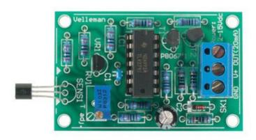
Sensore di temperatura per impieghi generali in grado di rilevare temperature comprese tra - 20°C e + 70°C. Facilmente interfacciabile con dispositivi di controllo, condizionamento e riscaldamento. Versione montata del kit 8220-8067.
