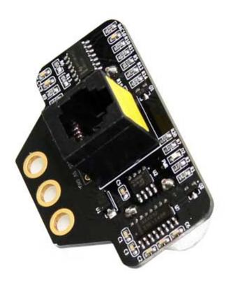
Sensore ad ultrasuoni che permette, interfacciato ad Arduino o altro microcontrollore, di misurare una distanza o di rilevare un ostacolo da 3 cm a 4 metri. Dispone di LED di stato, protezione da sovracorrente e interfaccia RJ25 a 6 pin. Con la libreria per Arduino, l'utente può ottenere direttamente una distanza e utilizzare in modo semplice il modulo. Può essere utilizzato con il robot mBot. Dimensioni (mm): 56,13x36x30, peso: 13 grammi.
