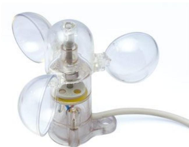
Semplice ma efficace sensore in grado di rilevare la velocità del vento. Contiene un contatto magnetico che invia un segnale impulsivo ad ogni rotazione del rotore azionato dalla forza del vento. Specifiche: una velocità del vento pari a 10 km/h corrisponde a 4 impulsi al secondo. Grado di protezione: IP44. Completo di cavo da circa 1 metro senza alcun connettore dalla parte terminale.
