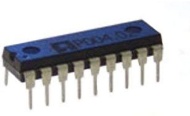
Questo microcontrollore Microchip PIC16F628A è programmato con il firmware 8-servo controller, permette di controllare fino a 8 servi RC. Il PIC richiede un quarzo da 8 MHz. Per maggiori dettagli potete controllare la guida utente [serial 8-servo controller](#), che comprende uno schema di un controller per servo basato su questo microcontrollore.
