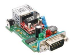
Vista interna del Serial Device Server DS203A. Il cuore del dispositivo è il modulo C203A-EV-RS
