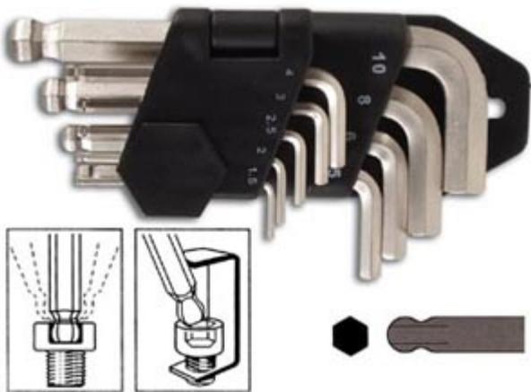
Serie professionale composta da 9 chiavi a brugola realizzate in acciaio al Cromo-Vanadio. Una delle due estremità è dotata di testa sferica esagonale che permette di operare agevolmente su viti non perpendicolari all'asse di lavoro. Completa di supporto in plastica.
