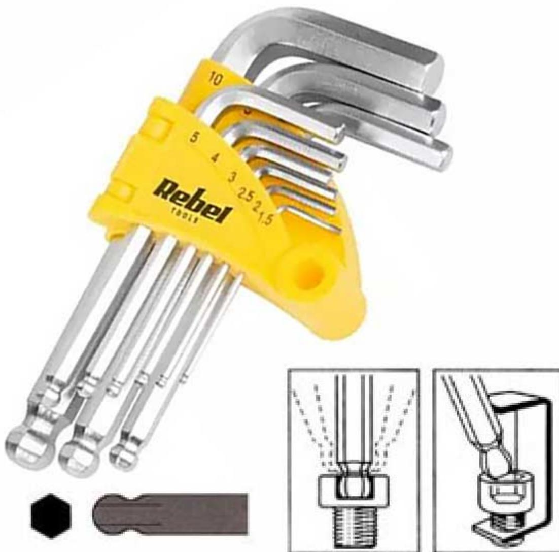
Serie professionale composta da 9 chiavi a brugola realizzate in acciaio al Cromo-Vanadio. Una delle due estremità è dotata di testa sferica esagonale che permette di operare agevolmente su viti non perpendicolari all'asse di lavoro. Completa di supporto in plastica.
