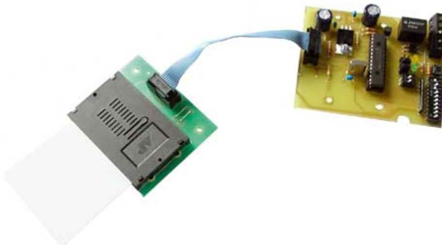
Attiva un dispositivo elettronico o apre una porta a comando elettrico solamente se viene inserita una ChipCard abilitata. Il sistema prevede la possibilità di impostare fino a 16 differenti gruppi di utenti. Il circuito può funzionare sia come programmatore di chip-card che come serratura vera e propria. Utilizza le chip card SLE4442 (cod. Futura CPC2K). Il kit comprende anche il lettore per chip card FT237K e 3 chip card vergini.
