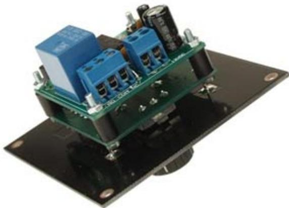
Tastiera codificata dall'esclusivo ed innovativo design dotata di encoder rotativo e display a 7 segmenti. Garantisce un elevato livello di affidabilità e sicurezza in quanto, l'uso di un encoder rotativo (sistema utilizzato per le casseforti) , rende impossibile determinare la sequenza del codice segreto.
