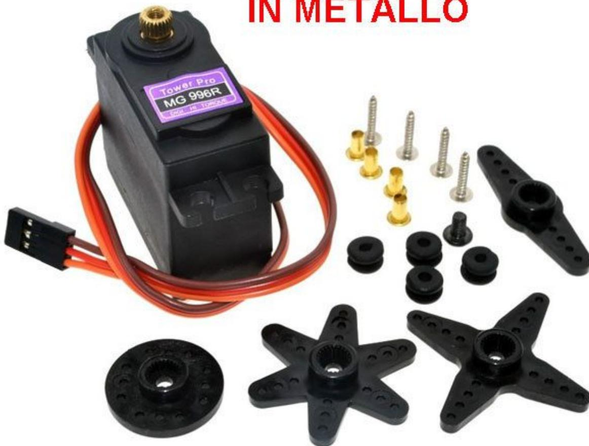
Servo analogico con ingranaggi in metallo e completo di accessori. Alimentazione: da 4,8 VDC a 6 VDC, coppia di torsione a carico. Dimensioni (mm): 42,7x40,9x20, peso: 55 grammi, temperatura di funzionamento: da 0°C a +60°C.
