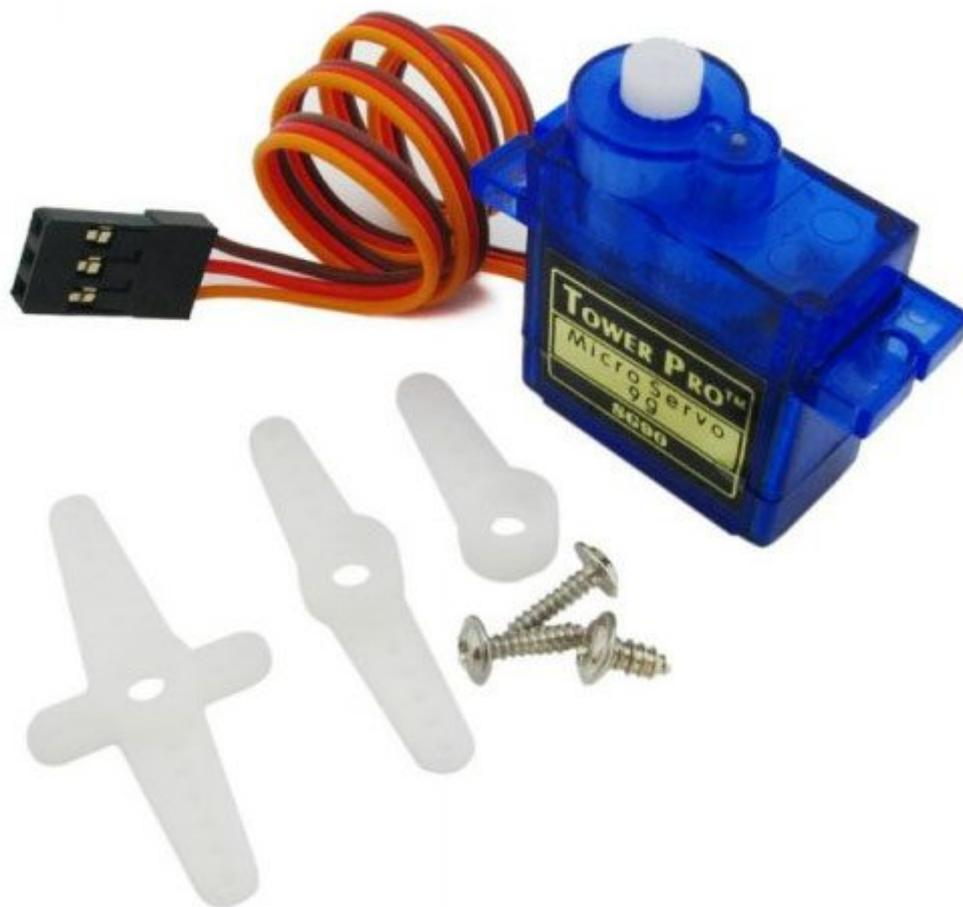
Servo analogico completo di accessori. Peso: 9 grammi, alimentazione: da 4,8 VDC a 6 VDC, coppia di torsione a 4,8V: 1,2 kg•cm, coppia di torsione a 6V: 1,5kg, rotazione: 180°, velocità a 4,8V: 0,12 sec/60°, velocità a 6V: 0,11 sec/60°, dimensioni (mm): 22,5x12x29.
