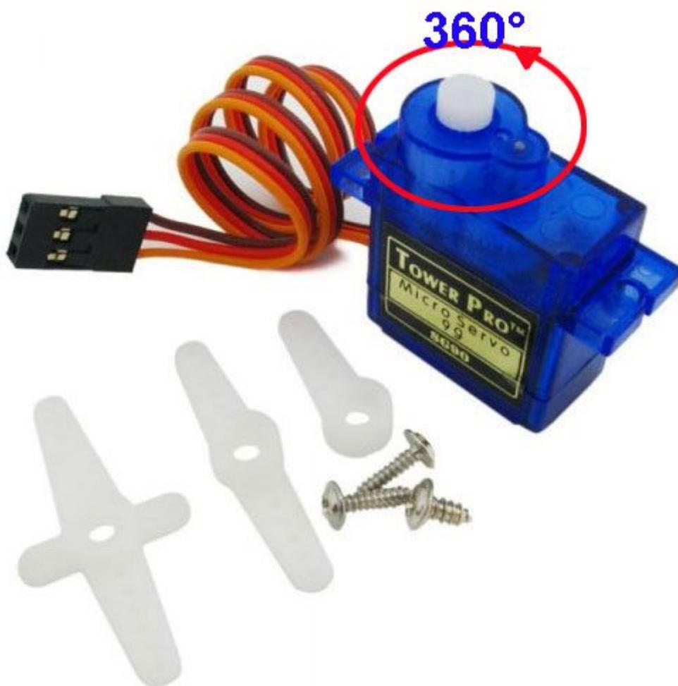
Servo analogico a rotazione continua (360°) completo di accessori. Peso: 9 grammi, alimentazione: da 4,8 VDC a 6 VDC, coppia di torsione a 4,8V: 1,2 kg•cm, coppia di torsione a 6V: 1,5kg, velocità a 4,8V: 0,12 sec/60°, velocità a 6V: 0,11 sec/60°, dimensioni (mm): 22,5x12x29.
