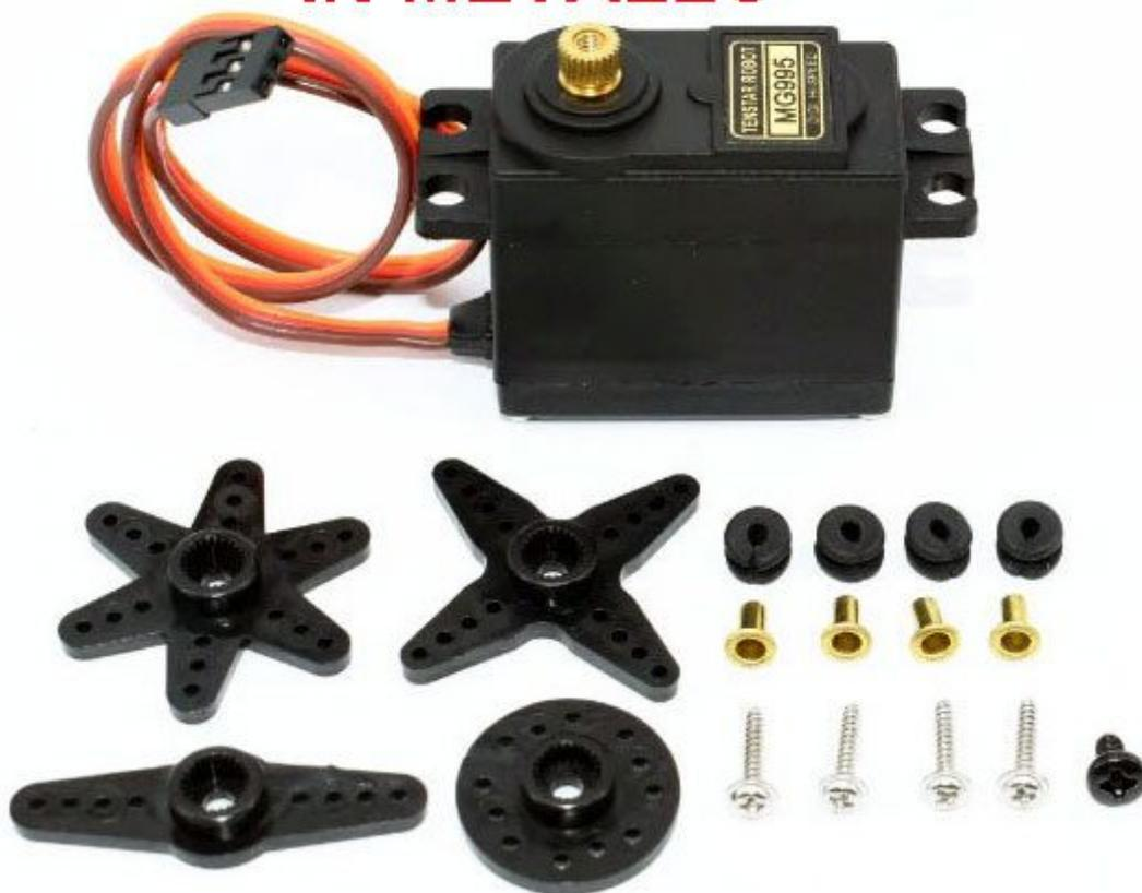
Servo analogico con ingranaggi in metallo e completo di accessori. Alimentazione: da 4,8 Vdc a 6 Vdc, coppia di torsione: 13 kg•cm (4.8V) – 15 kg•cm (6V), rotazione: 180°, velocità a 4,8V: 0,20 sec/60° senza carico, velocità a 6V: 0,16 sec/60° senza carico. Dimensioni (mm): 40,6x39,5x20, peso: 55 grammi, temperatura di funzionamento: da 0°C a +55°C.
