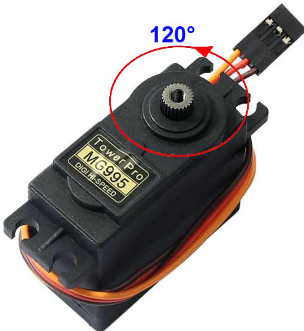
Servo analogico completo di accessori. Alimentazione: da 4,8 Vdc a 6 Vdc, coppia di torsione: 13 kg•cm (4.8V) – 15 kg•cm (6V), rotazione: 120°, velocità a 4,8V: 0,20 sec/60° senza carico, velocità a 6V: 0,16 sec/60° senza carico. Dimensioni (mm): 54,2x39,5x20, peso: 55 grammi, temperatura di funzionamento: da 0°C a +55°C.
