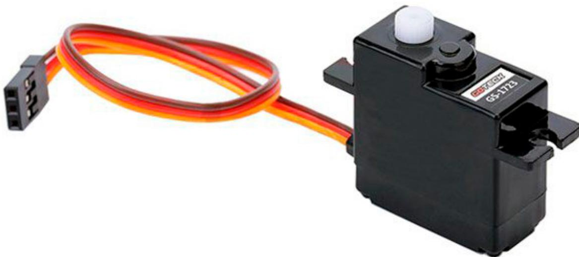
Servo analogico completo di accessori. Peso: 17 g, alimentazione: da 4,8 Vdc a 6 Vdc, coppia di torsione: 2,3 kg•cm, velocità: 0,18 sec/60°, dimensioni (mm): 28,5x13,3x30,6.
