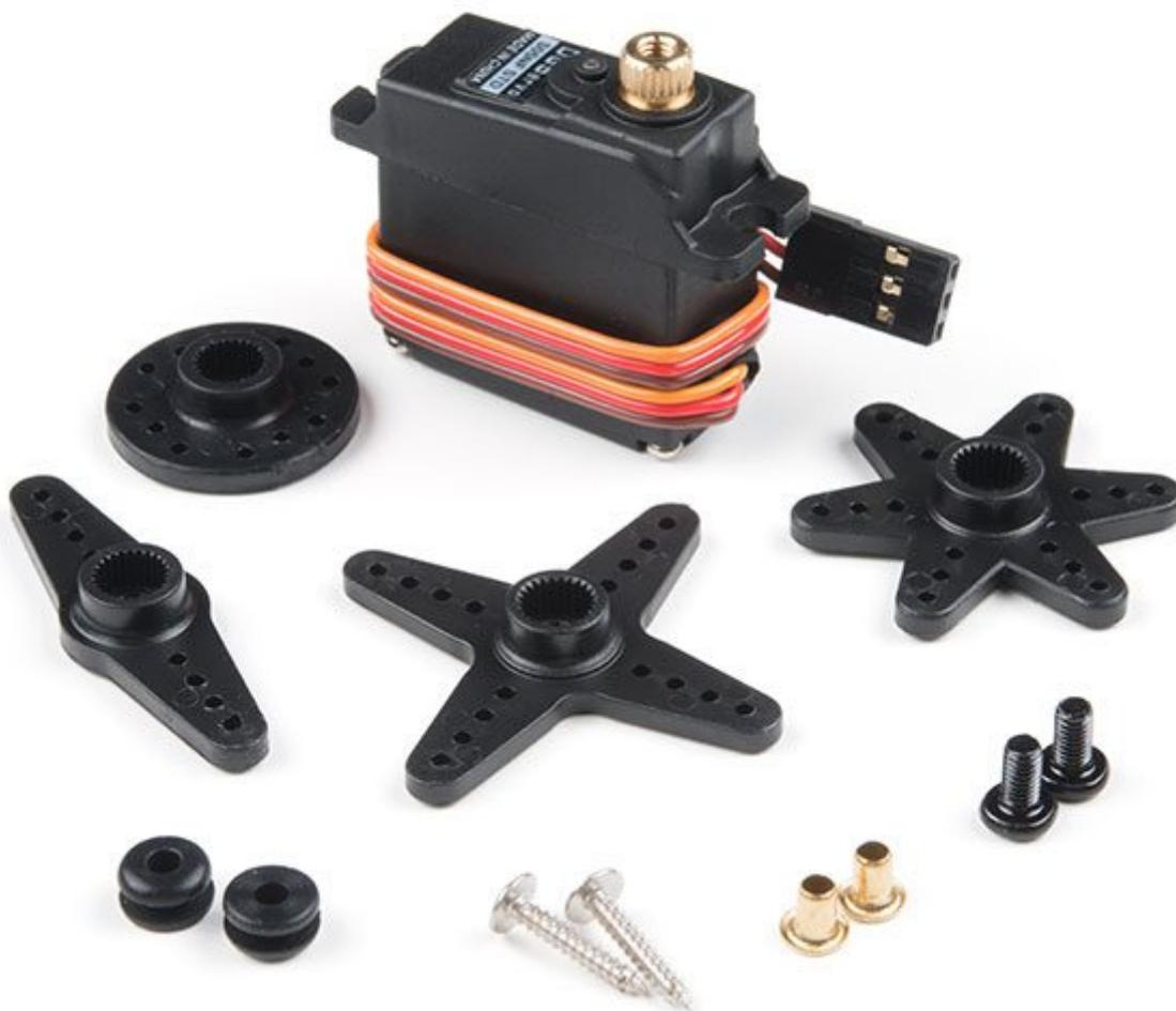
Servo analogico con ingranaggi in metallo, coppia di torsione di 3,2 kg•cm a 6 V, rotazione 180° e cavo dotato di connettore standard compatibile JR, Futaba, Hitec. La confezione comprende il servo e gli accessori.
