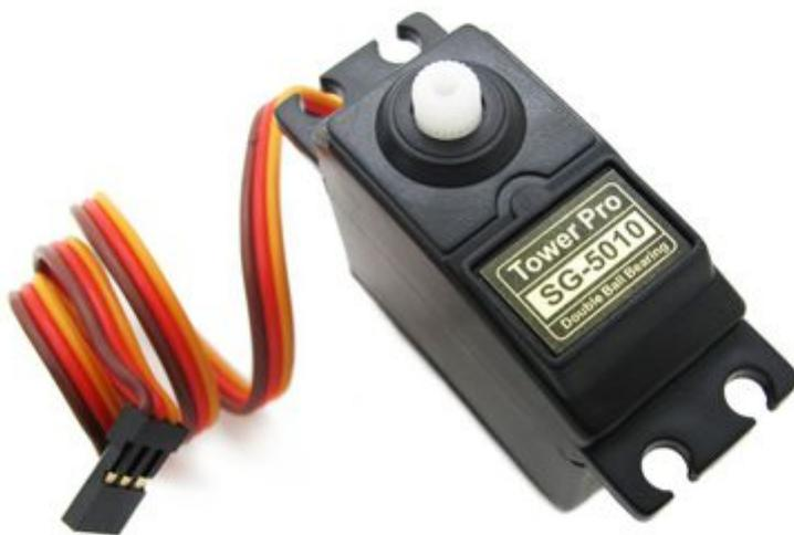
Servo analogico completo di accessori. Alimentazione: da 4,8 VDC a 6 VDC, coppia di torsione a 4,8 V: 5,5 kg-cm, coppia di torsione a 6 V: 6,5 kg-cm, rotazione: 180°, velocità a 4,8V: 0,19 sec/60° senza carico, velocità a 6 V: 0,15 sec/60° senza carico. Dimensioni (mm): 40,6x39,5x20, peso: 42,5 grammi, temperatura di funzionamento: da -20°C a +60°C.
