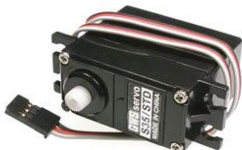
Ha tutte le caratteristiche di un comune servo ma può girare di 360° in modo continuo. Può essere utilizzato, al posto di motori DC o motoriduttori, per piattaforme robot con ruote. Peso: 42 g, alimentazione: da 4,8 Vdc a 6 Vdc, ingranaggi: Nylon, velocità: 0,15 sec/60° (67 RPM) @ 4,8 V, velocità: 0,13 sec/60° (77 RPM) @ 6 V, coppia di torsione: 2,5 kg\*cm @ 4,8 V, coppia di torsione: 2,8 kg\*cm @ 6 V, dimensioni: 39,6 x 20,1 x 35,6 mm. Completo di accessori.
