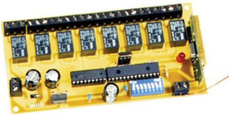
Servocomando ad 8 canali operante a 433,92 MHz realizzato con i nuovi moduli FM dell'Aurel. La modulazione in frequenza garantisce una elevatissima immunità ai disturbi ed una notevole portata. Gli otto canali possono essere attivati indipendentemente l'uno dall'altro e le uscite mantengono lo stato impostato sino a quando le due unità restano in collegamento tra loro. Il ricevitore comprende tutti i componenti, la basetta forata e serigrafata, il microcontrollore programmato e il modulo Aurel.
